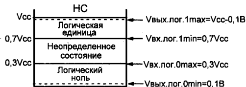
Рис. 2.2. Теоретические диапазоны входных и выходных напряжений КМОП-микросхем HC-серии в относительных единицах
