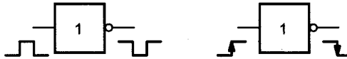
Рис. 3.17. Инверсия уровня сигнала (слева) и фронта сигнала при его прохождении через логический элемент НЕ
