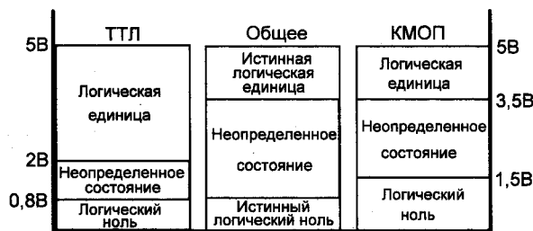
Рис. 2.1. Обобщенные диапазоны входных напряжений ТТЛ и КМОП-микросхем
